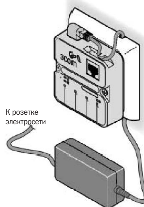
Рис. 2: Для обеспечения локального питания коммутаторов IntelliJack необходимо наличие розетки электропитания рядом с местом монтажа коммутатора.
