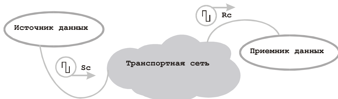
Рис. 3.1. Схема синхронной передачи данных через транспортную сеть; Sc и Rc – непрерывные последовательности синхроимпульсов, передаваемых в сеть и принимаемых из сети в качестве сигналов подтверждения истинности битов данных
