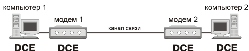
Рис. 1.3. Система, использующая компьютеры, выполненные в виде устройств DCE. Неясно, где здесь “оконечное оборудование данных” ?
