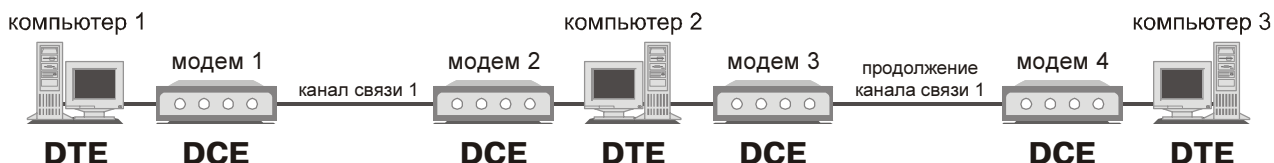
Рис. 1.2. Расширенная система. Неясно, как теперь правильно назвать компьютер 2: устройством DTE или DCE ?
