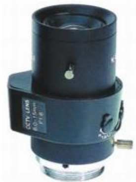
Объектив варифокальный, с автоматической настройкой диафрагмы, приводом AC f 6-15 мм, F 1.6
